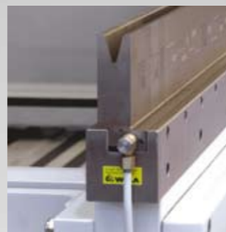
🇮🇹 Bloccaggio idraulico Wila per matrici. 🇬🇧 WILA hydraulic bottom tool clamping.
