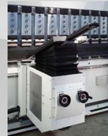
🇮🇹 Accompagnatori lamiera anteriori, che permettono la lavorazione di lamiere di medie e grandi dimensioni. Sono gestiti dal CNC (A1- A2) e perfettamente sincronizzati con gli assi di piega (Y1- Y2) 🇬🇧 Sheet followers allow to handle big and medium size sheets. Controlled through CNC (A1-A2) they are perfectly synchronized with the bending axes (Y1-Y2)
