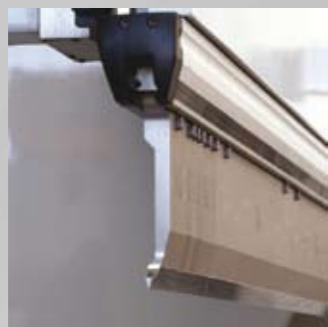
🇮🇹 Bloccaggio idraulico Wila per punzoni. 🇬🇧 WILA hydraulic top tool clamping.
