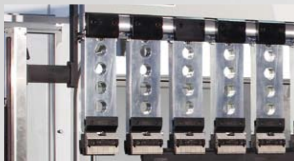
🇮🇹 Bloccaggio idraulico Wila per punzoni. 🇬🇧 WILA hydraulic top tool clamping.
