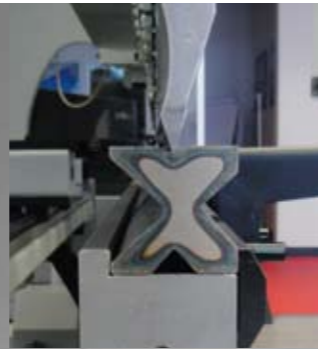
🇮🇹 Bloccaggio matrice standard con staffe per frazionati. 🇬🇧 Standard die clamping with clamps for sectionized tools.
